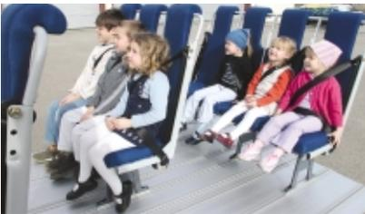
Le siège pour écoliers peut être installé dans divers types de véhicules et est équipé d'un plancher spécial, homologué lui aussi. Il se monte sur le plancher d'origine et permet d'accueillir également des sièges pour adultes.
